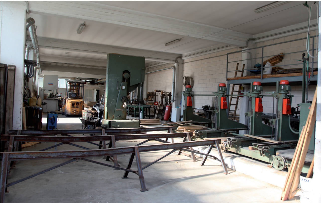
Interno della nuova segheria. In primo piano sega-tronchi con carrello
