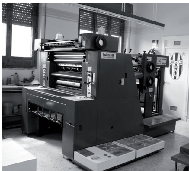
Macchina per la stampa in offset, 65 x 95
