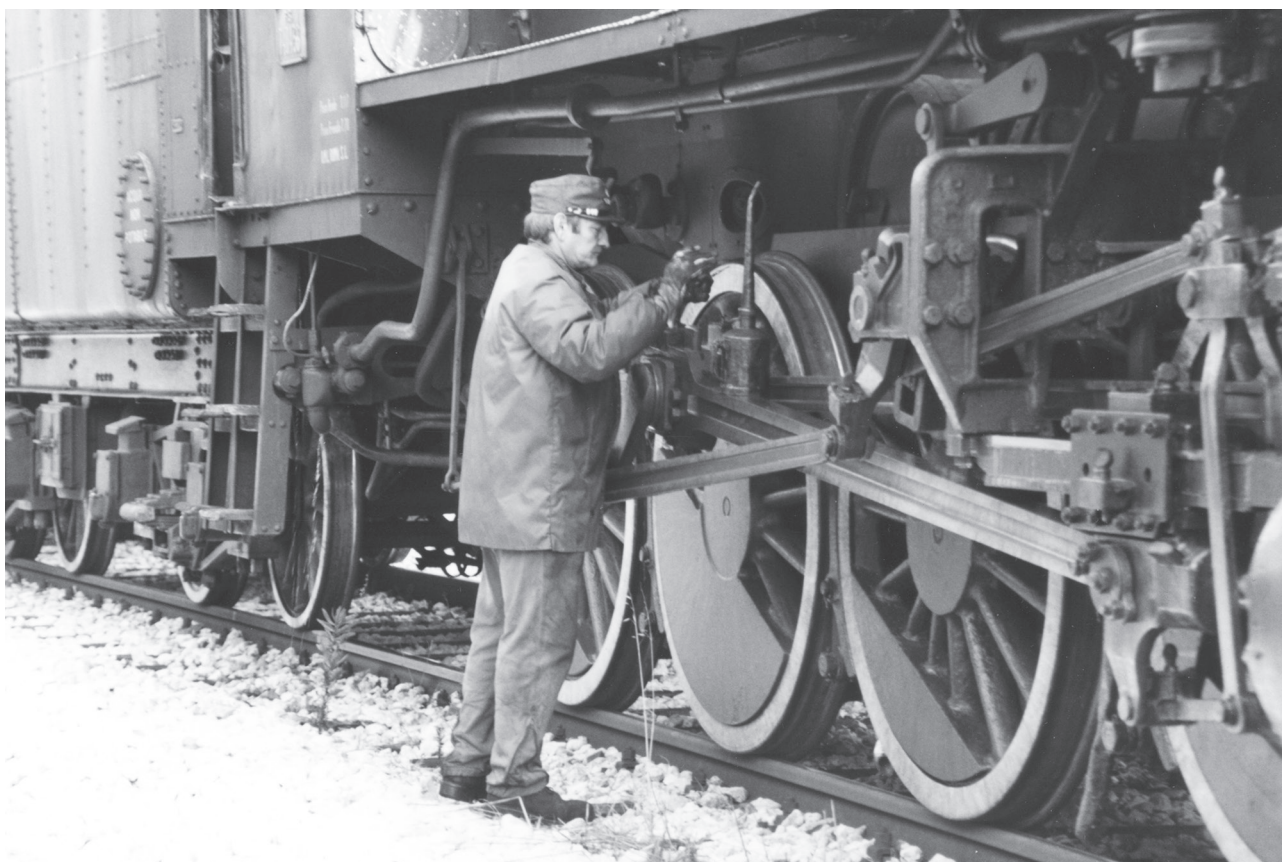
Sosta nella stazione di Castelfranci. Un macchinista sta oliando i complessi ingranaggi della locomotiva. Foto C. Cresta
